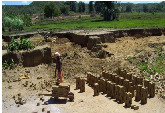
Photo 6 : Fabrication de briques sur une rizière pendant la saison morte
